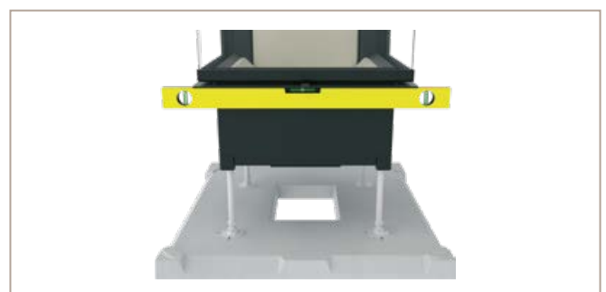
Abb. 32: Kamineinsatz mit Wasserwaage ausrichten
